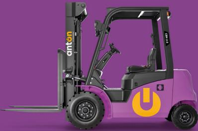
Angetrieben von moderner **Lithium-Ionen-Technologie** bietet der Elektrostapler längere Laufzeiten, kürzere Ladezyklen und eine wartungsfreie Batterie. Damit Sie produktiv bleiben.
