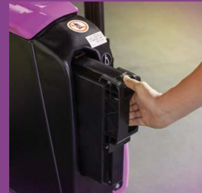
Eine zweite Batterie (optional) ermöglicht längere Einsatzzeiten ohne Unterbrechung.
