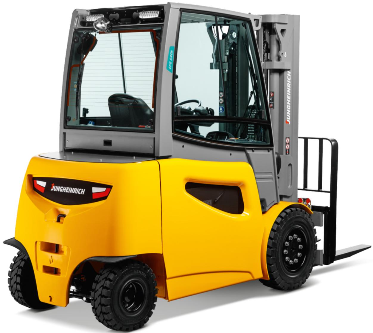
Электрический четырехколесный погрузчик
