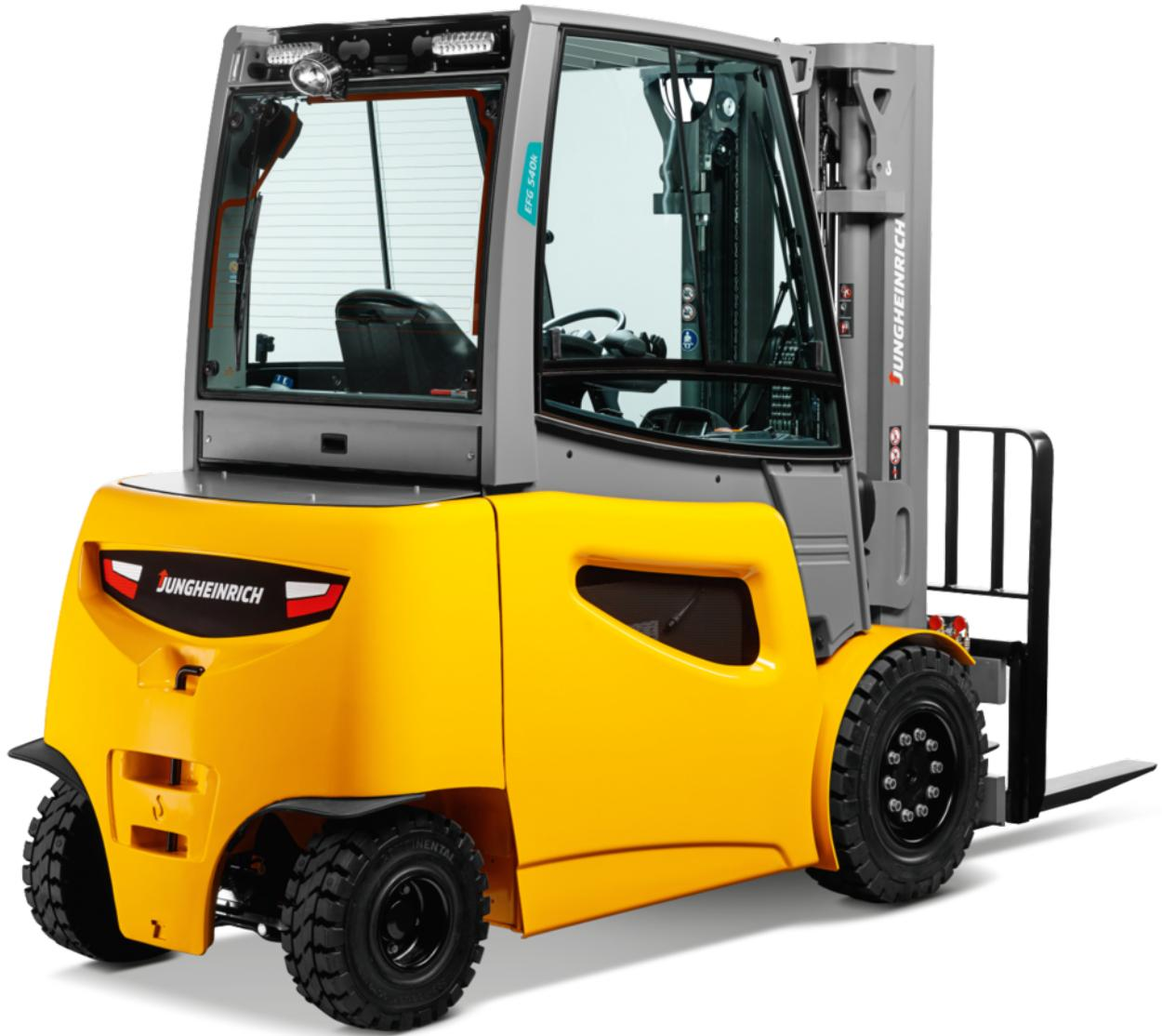
Электрический четырехколесный погрузчик
