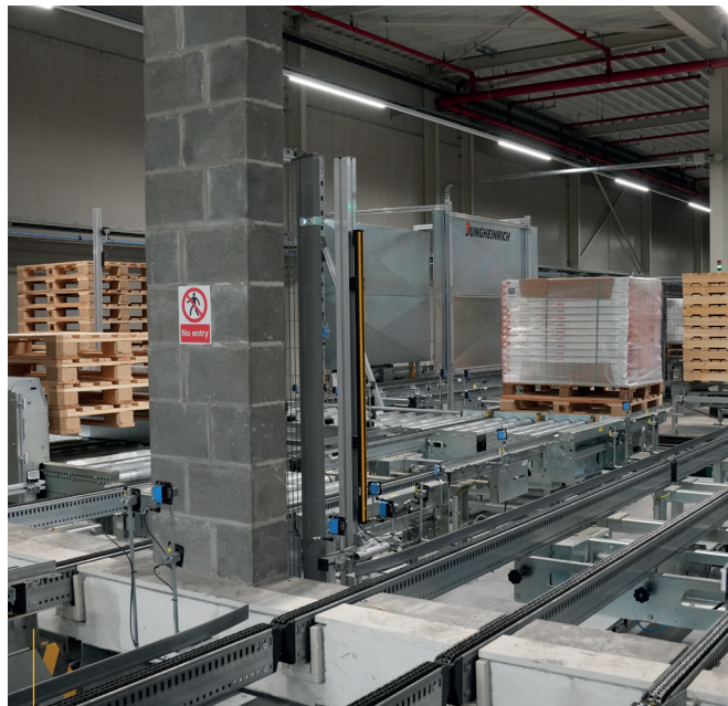
Les trois lignes d'entrée / sortie forment la zone de transition physique entre la production et l'entrepôt.
