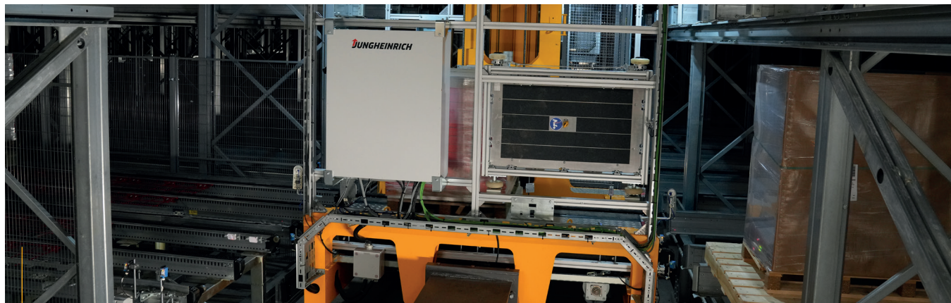
Les deux transstockeurs de 33,5 mètres de hauteur sont équipés d'une navette à double profondeur qui peuvent également accueillir des palettes de 1 200 x 2 400 mm.
