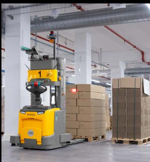
Mobile Robots ERC 213a unterstützen die Mitarbeitenden tatkräftig in der Produktionsver- und -entsorgung.
