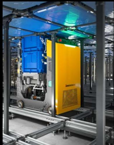
Fünf energieeffiziente Shuttles transportieren jeweils zwei Behälter mit bis zu 50 kg Nutzlast.
