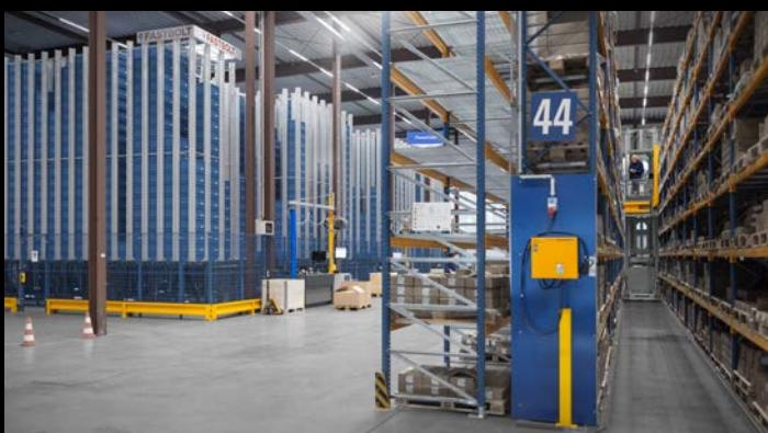
Durch die Umlagerung gering befüllter Paletten aus dem Schmalgang-Palettenlager in den PowerCube wurden Palettenplätze freigegeben, um dort wieder Vollpaletten einzulagern zu können.
