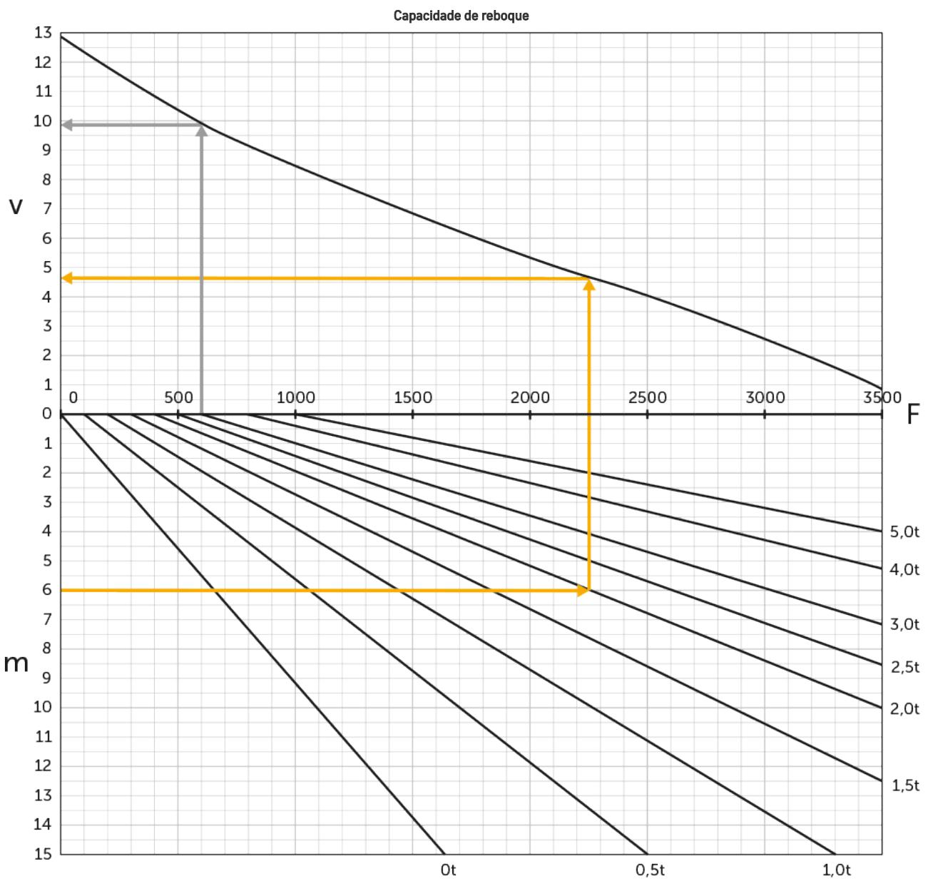
$v$ =velocidade [km/h],  $m$ =subida [%],  $F$ =força de tração [N]
