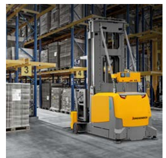
Beim Einsatz rund um die Uhr bezieht der EKKa seine Energie direkt über Stromschienen am Regal.
