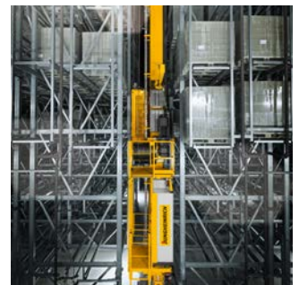
Paletten-Regalbediengerät: Geschwindigkeit und Präzision beim Ein- und Auslagerungsprozess.
