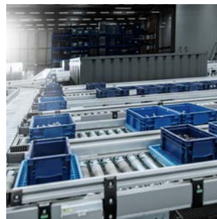
Behälterfördertechnik für den Transport von Produkten in Kartons, Behältern und Tablaren bis 50 kg.
