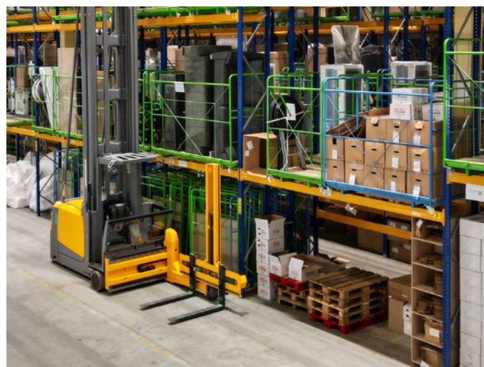
De unieke smalle gangentrucks zijn uitgevoerd met het optionele Floor Pro-systeem, dat hogere snelheden en daarmee een hogere productiviteit mogelijk maakt.
