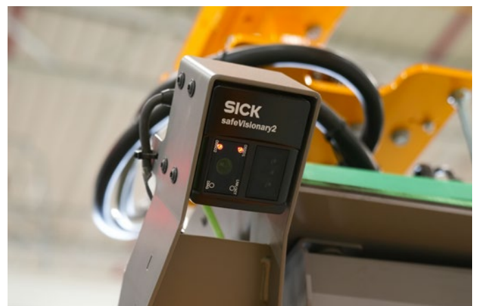
De speciale sensor zorgt ervoor dat de AGV hoger kijkt dan 20 cm boven de rijweg en vergroot de veiligheid van het voertuig.
