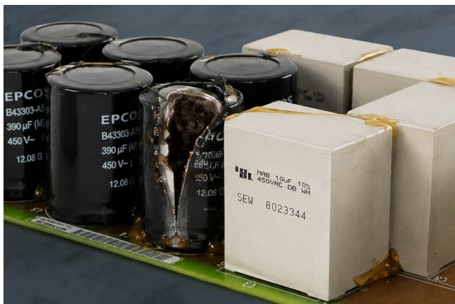
Schäden nach Inbetriebnahme aufgrund unformierter Lagerung.
