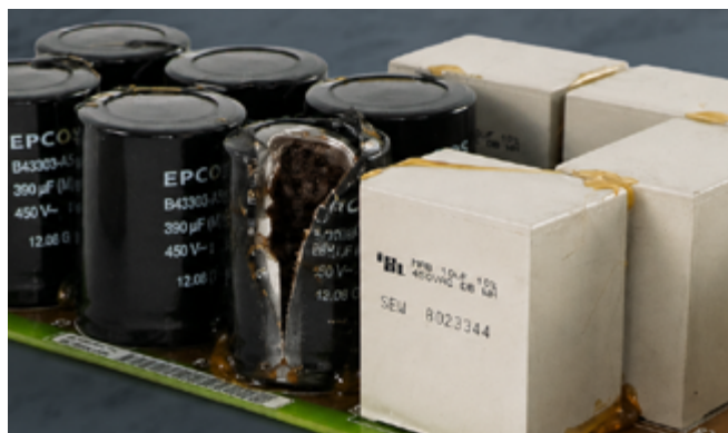
Dommages survenus après la mise en service en raison d'un stockage sans formage préalable.
