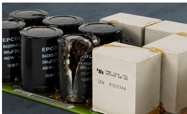
Danni verificatisi dopo la messa in funzione a causa di uno stoccaggio non corretto.
