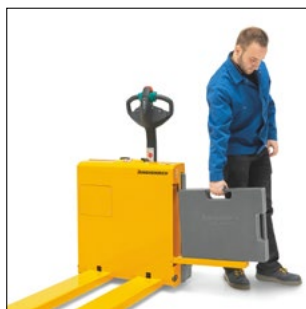
Cambio lateral de batería en la EJE 112i
