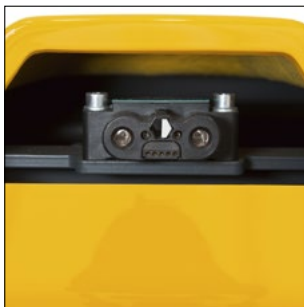
Conexión eléctrica de remolques
