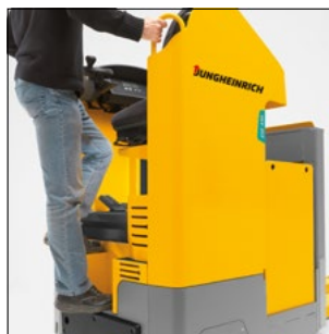
Acceso seguro mediante peldaño bajo y estribo
