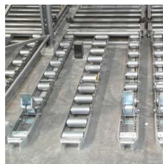
Kolmiosainen rakenne, jonka ulosottokorkeus on noin 66 mm, mahdollistaa lavojen sujuvan ulosoton.
