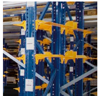
Yhden lavapaikan hyllystö: Syvyys suunnassa asennetut kulmaprofiilit hoitavat tukitoiminnon; lisätilaa saadaan korkeussuunnassa.
