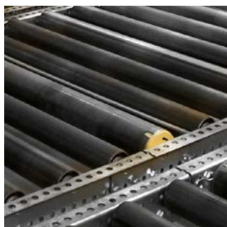
Läpivirtaushyllyissä jarrurullat säätelevät lavojen kuljetusnopeutta.
