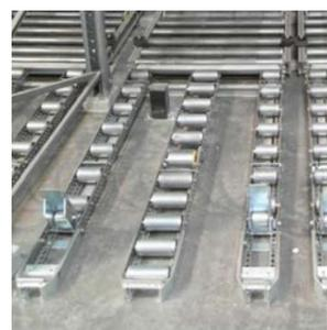
La conception en trois rails de la nappe arrivant au sol, avec une hauteur de sortie d'environ 66 mm, assure un retrait en douceur des palettes même au transpalette manuel.
