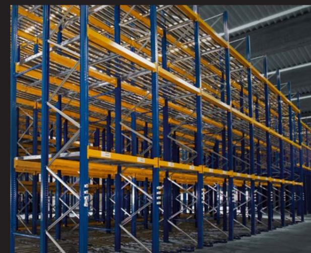
Avec le rayonnage dynamique, le stockage s'effectue généralement dans le sens longitudinal par un chariot élévateur de type frontal ou à mât rétractable.
