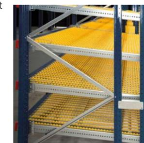
Le stockage dynamique de cartons permet un réglage de la hauteur des niveaux au pas de 20 mm et de l'inclinaison des nappes de rails à galets.
