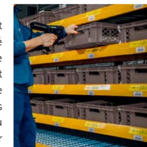
Le principe FIFO du stockage dynamique de cartons permet de contrôler les lots et les dates de péremption.
