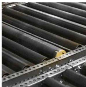
Dans le cas du stockage dynamique de palettes, des rouleaux de freins contrôlent la vitesse de descente des charges.
