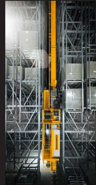
Les entrepôts à rayonnages grande hauteur font figure de géants. Associés au transtockeur adéquat, ils permettent des déplacements entièrement automatisés de charges à une vitesse record.
