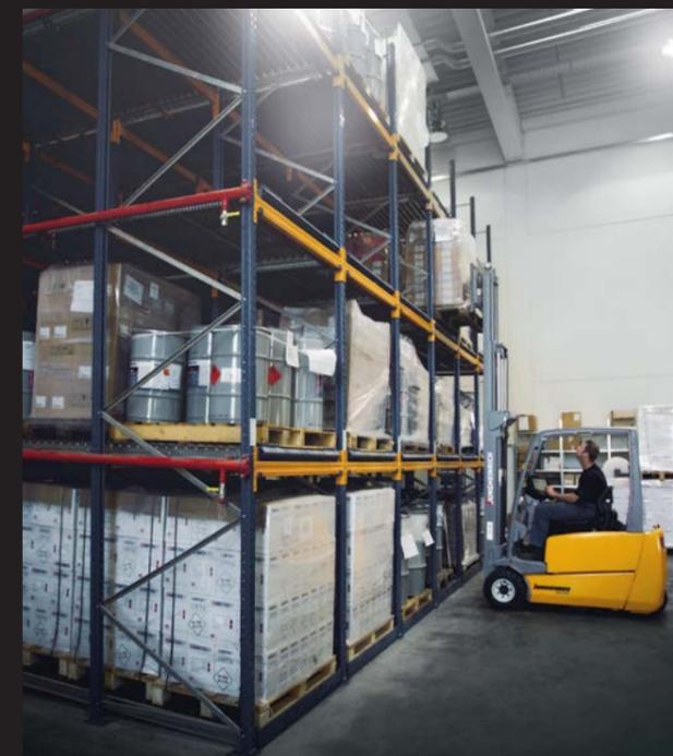
Ce type de rayonnage « push back » présente la meilleure optimisation de l'espace avec les plus faibles temps d'acheminement. Le chargement et le déchargement sont 30 à 35 % plus rapides qu'avec un rayonnage de type accumulation.
