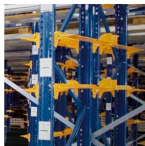
Rayonnage à emplacements uniques : les cornières supports permettant un appui des charges dans la profondeur autorisent un gain de place en hauteur et parfois le gain d'un niveau supplémentaire.
