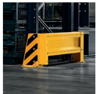
Per proteggere gli scaffali da una collisione con i mezzi di movimentazione, le protezioni dei mezzi vengono utilizzate come protezione paracolpi.
