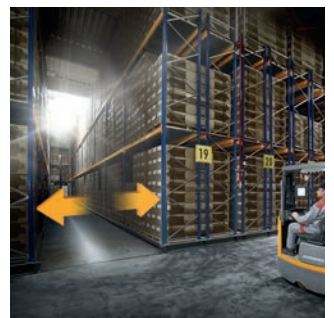
Più efficienza: nella scaffalatura mobile con collegamento WMS, la corsia di lavoro si apre già durante la partenza.
