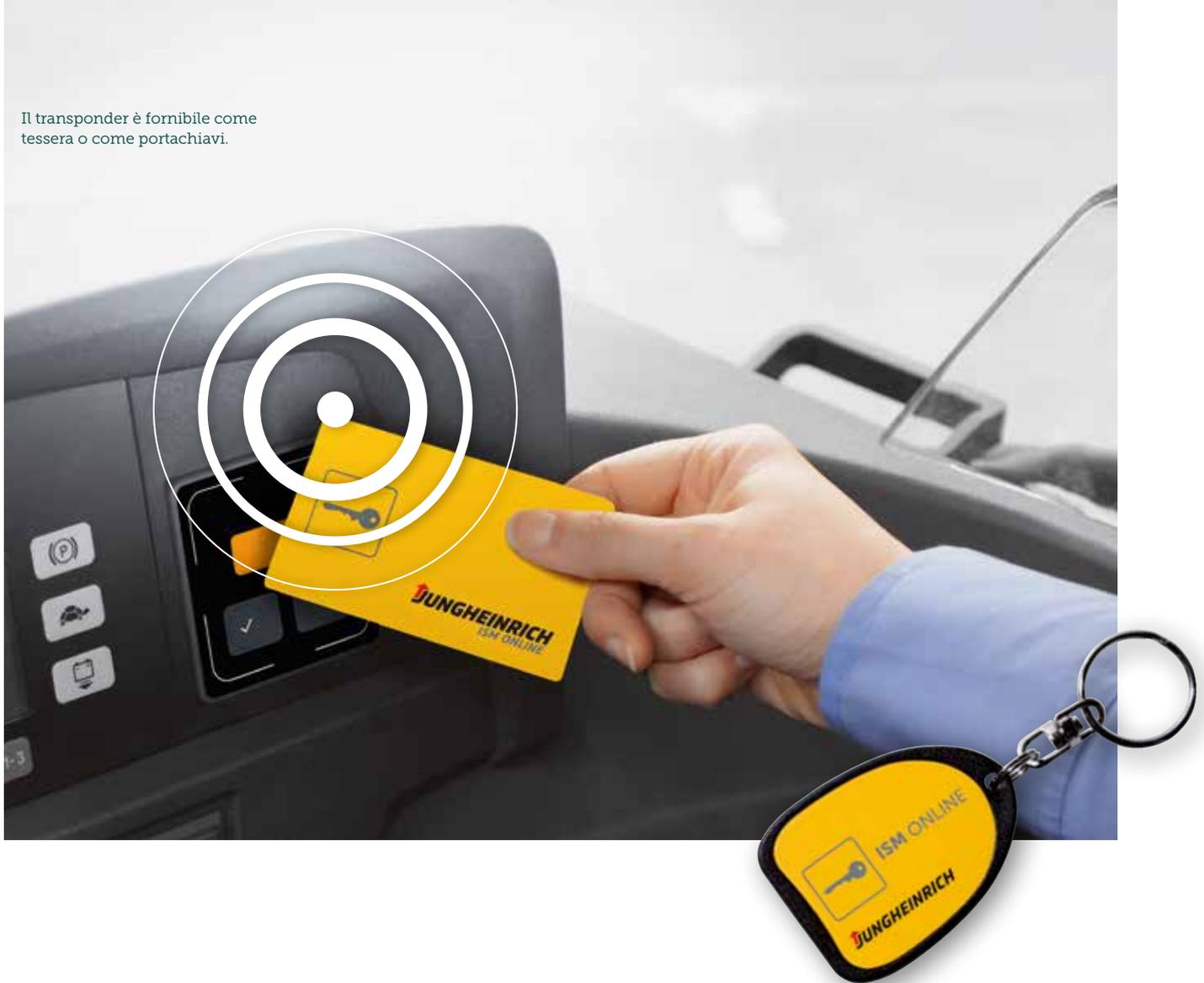
**I moduli Sicurezza e Produttività completano le analisi della flotta. Entrambi i moduli sono impiegati in combinazione con i componenti del carrello (moduli d'accesso, data recorder con sensore urti e trasmettitore). I componenti installati sul carrello trasmettono i dati registrati, con l'aiuto dei cosiddetti gateways, al portale di gestione. Qui vengono combinati con i dati commerciali per formare una vasta base di informazioni per l'utente.**
