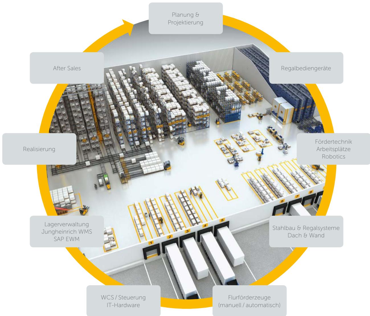
Fahrerlose Transportsysteme (FTS) erlauben es Ihnen, Ihr Lager als reines Automatiksystem, aber auch im Mischbetrieb mit manuellen Fahrzeugen und Personen zu führen. Diese automatisierten Flurförderzeuge basieren auf ausgereiften Jungheinrich- Serienfahrzeugen und können bei Bedarf auch manuell oder semiautomatisch betrieben werden. Damit können hochredundante und beliebig skalierbare Lösungen realisiert werden.
