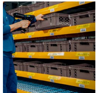
Načelo FIFO pretočnega regala za drobni material omogoča spremljanje serij in datumov uporabnosti.
