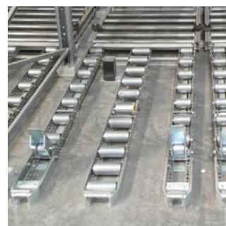
Tridnelna konstrukcija z izhodno višino približno 66 mm zagotavlja nežno odstranjevanje palet.
