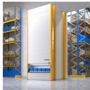
Vertikalni zalogovniki s pladnji zahtevajo le majhno površino in so združljivi s številnimi skladiščnimi sistemi.
