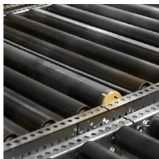
S pretočnim regalom za palete zavorni valji nadzorujejo hitrost premikajočih se palet.
