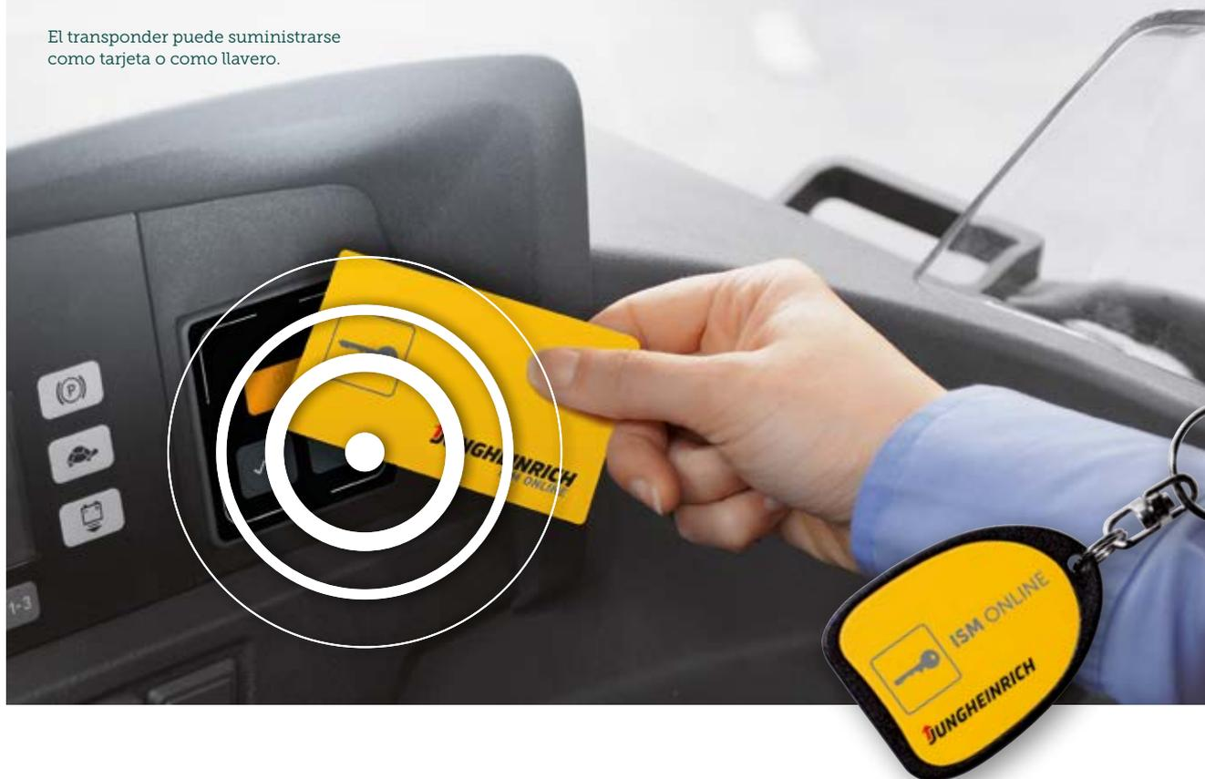
Los módulos «Seguridad», «Productividad», «Gestión de la batería»\* y «Control de acceso» completan el análisis de flotas. Estos módulos se utilizan en combinación con los componentes de las carretillas (módulo de acceso, registrador de datos con sensores de choques y emisor). Los componentes integrados en las carretillas envían los datos registrados con ayuda de un gateway al portal de gestión, donde se combinan con los datos comerciales y forman así la base para una información completa.
