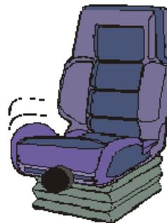
Das Federungssystem des Sitzes muss derart ausgewählt sein, dass das System bei normalem Einsatz mit hoher Wahrscheinlichkeit nicht an den oberen oder unteren Endlagen anschlägt. Ein Berühren der Endstopper führt zu stoßhaltigen Schwingungen und erhöht damit das Risiko einer Rückenschädigung.
