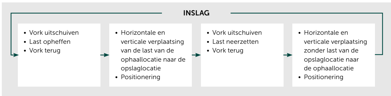
Afbeelding 1: inslagcyclus van een smalle gangentruks
