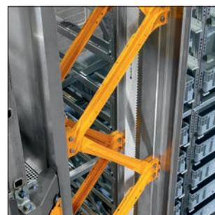
Struttura leggera ad alta efficienza con profili in alluminio prodotti mediante estrusione
