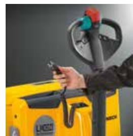
Zwischenladen an jeder Steckdose: das integrierte Ladegerät.
