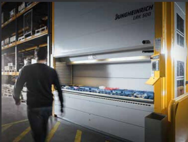
**Lift-/Paternosterregal:** Ein geschlossenes System, bei dem die Kleinteile auf dem kürzesten Weg entweder per Lift oder durch Rotation zur Bedienöffnung befördert werden.
