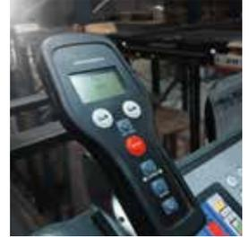
Bedienung des Shuttles per Handfunkterminal.
