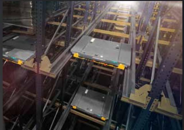
**Shuttle-Kompaktlagersystem:** Hier wird die Palette von einem Carrier im Regalkanal unterfahren. Das ermöglicht verbesserte Raumnutzung und zugleich eine höhere Umschlagsleistung.
