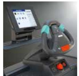
Höhenverstellbare Multifunktionslenkung jetPILOT für automobilkonformes Fahren.
