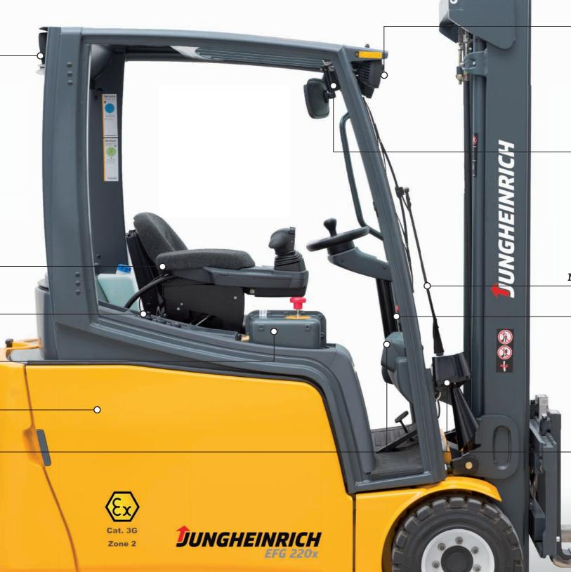
LED-Scheinwerfer mit speziellen Steckern und Schutzgittern
