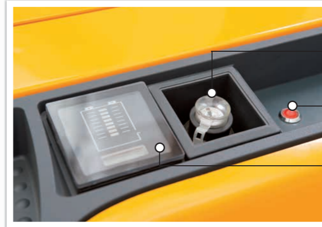
Batterieentladeanzeige mit Schlagschutz
