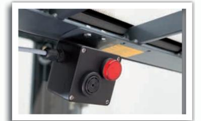
Enveloppe anti déflagration des éléments de commande des projecteurs et gyrophares.
