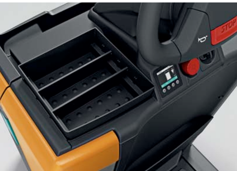
Caja portaobjetos sobre la tapa de la batería
