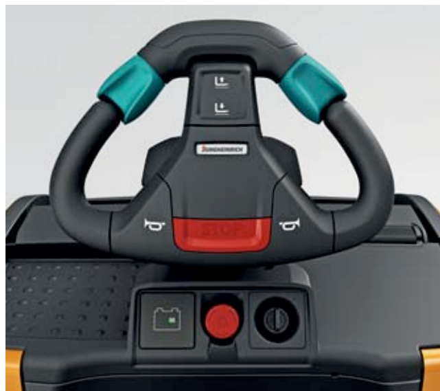
JetPilot: el volante multifuncional ajustable en altura
