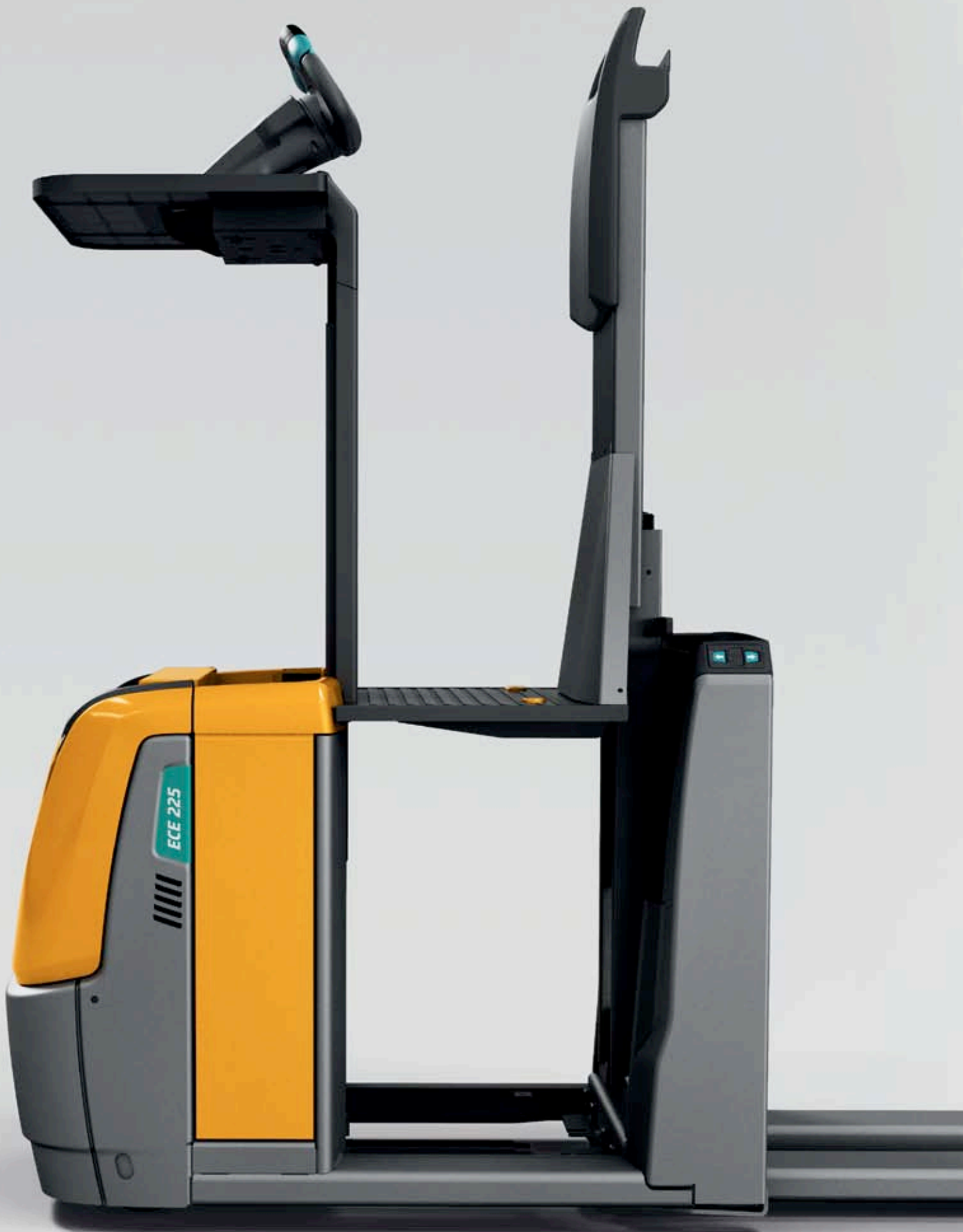
Plataforma de pie elevable con unidad de mando (HP-LJ)
