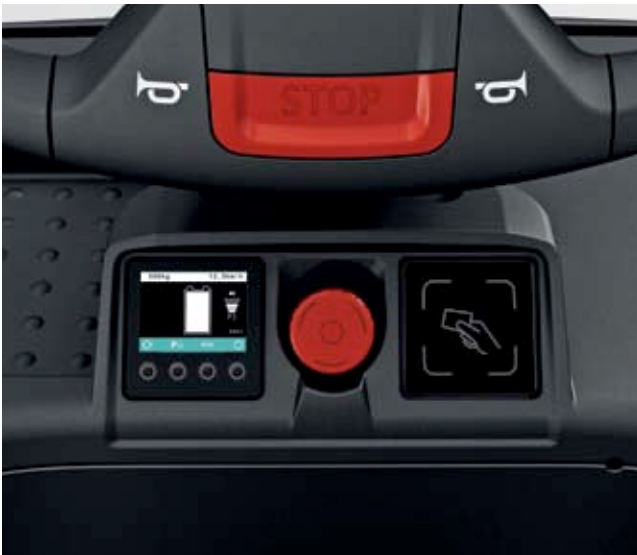
Pantalla de 2 pulgadas y transpondedor EasyAccess
