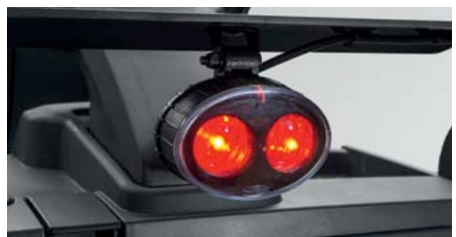
Floor-Spot para maniobrar de forma segura
