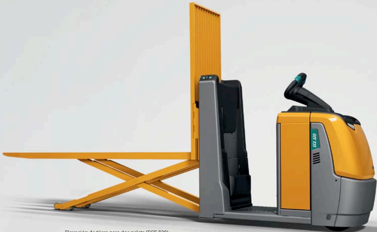
Elevación de tijera para dos palets (ECE 320)
