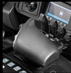
**soloPILOT:** Alle Hydraulikfunktionen, Fahrrichtungswahl und Hupe in einem Hebel. Millimetergenaue Steuerung sämtlicher Funktionen.
