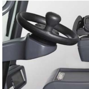
Die **Elektrische Parameterlenkung** ermöglicht präzises Lenken und minimiert ungewollte Lenkbewegungen.
