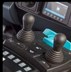
**duoPILOT:** Feinfühliges Steuern des Fahrzeuges über zwei unabhängige Hebel. Auf Wunsch frei konfigurierbar.
