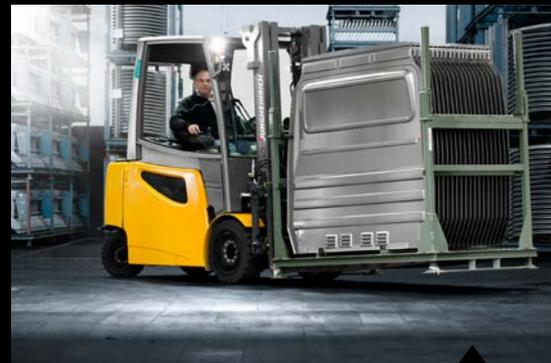
**EFG 425** mit geringen Vibrationen dank Entkoppelung der Kabine vom Chassis.
