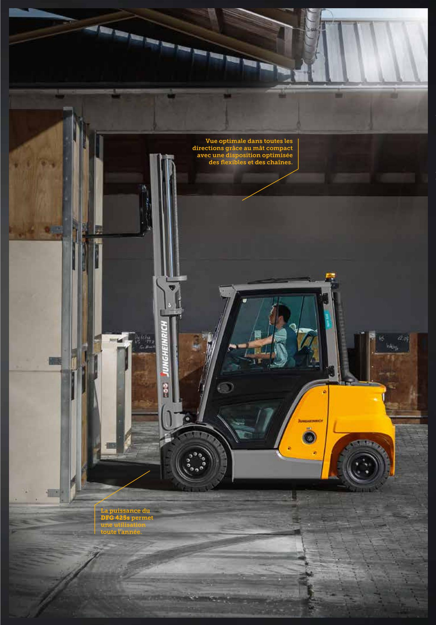
Vue optimale dans toutes les directions grâce au mât compact avec une disposition optimisée des flexibles et des chaînes.
