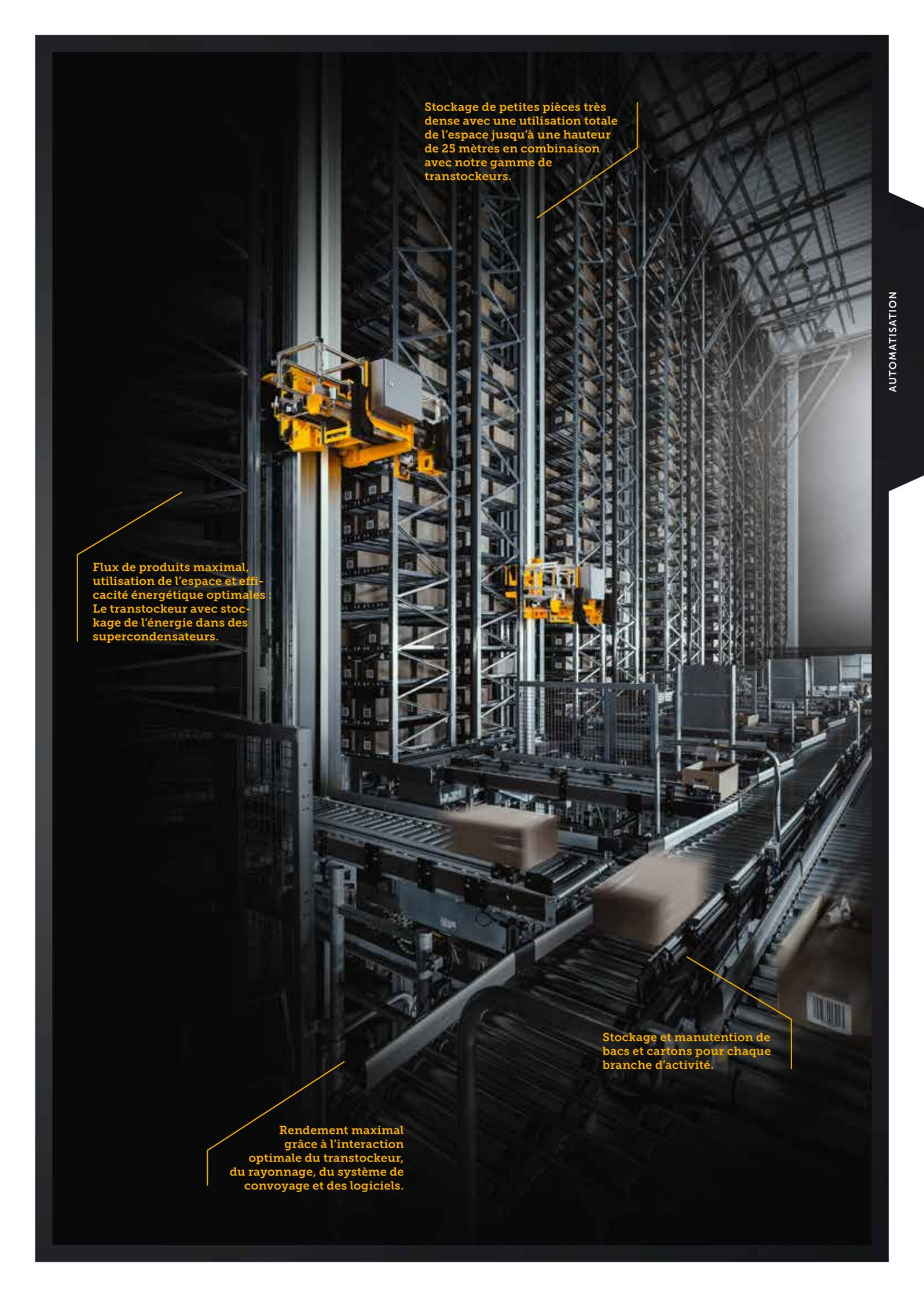
Stockage de petites pièces très dense avec une utilisation totale de l'espace jusqu'à une hauteur de 25 mètres en combinaison avec notre gamme de transtockeurs.
