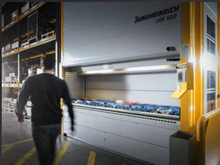
**Rayonnage à élévation (Liftregal) / rayonnage Paternoster :** Système fermé automatisé composé de tiroirs ou de balancelles dans lesquelles les pièces sont amenées vers la sortie (picking) par ascenseur vertical ou rotatif.
