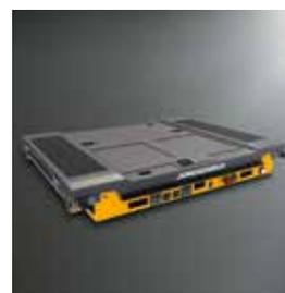
La navette UPC (Under Pallet Carrier) se déplace de manière autonome sous les palettes stockées.
