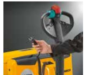
Charge de la batterie possible à tout moment sur une prise secteur grâce au chargeur intégré.
