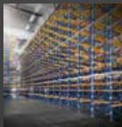
**Rayonnage à emplacement unique :** Il offre un accès direct à tous les articles et une utilisation optimale de l'espace, en particulier pour les caisses en grillage métallique et les charges individuelles élevées.
