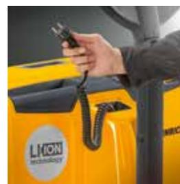
Chargement intermédiaire de la batterie à technologie Lithium-ion grâce au chargeur intégré.
