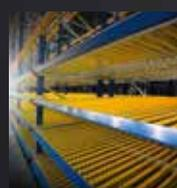
**Rayonnage dynamique :** Dans ce système, les pièces sont acheminées vers la sortie (picking) par gravité sur des nappes à rails à galets plastiques. Idéal pour une préparation de commandes avec un rendement élevé (nombre de picks/heure).
