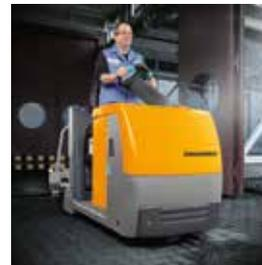
Grâce à la technologie asynchrone, les tracteurs électriques sont sans dégagement d'émissions, silencieux et puissants.
