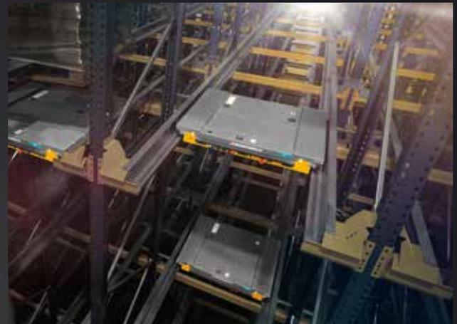
**Système de stockage compact par navette :** Les navettes se déplacent sous le stock de palettes pour les transporter par le rack. Cela permet une meilleure utilisation de l'espace et une meilleure rotation. Cela permet une meilleure optimisation de l'espace tout en limitant les temps d'accès des caristes dans des installations compactes.
