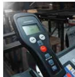
Commande de la navette par terminal radio portable.
