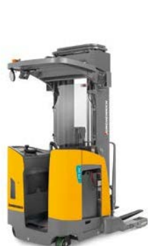
ETR 214-320/316d Chariot à fourches rétractables Hauteur de levée maxi : 11354 mm Capacité de charge maxi : 2000 kg
