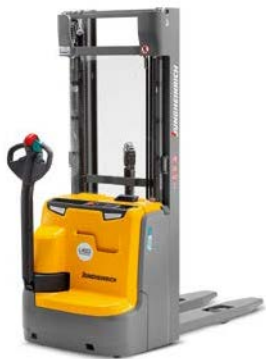
EJC 212-230* Gerbeur électrique accompagnant Hauteur de levée maxi : 6000 mm Capacité de charge maxi : 3000 kg
