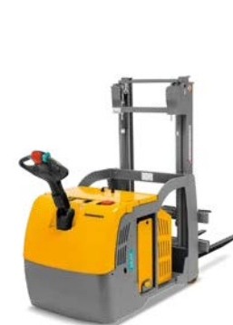
EJG 106-216 Gerbeur électrique accompagnant Hauteur de levée maxi : 5350 mm Capacité de charge maxi : 1600 kg
