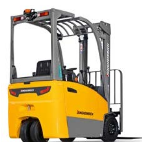
EFG BB 216k Chariot élévateur électrique trois roues Hauteur de levée maxi : 6500 mm Capacité de charge maxi : 1600 kg
