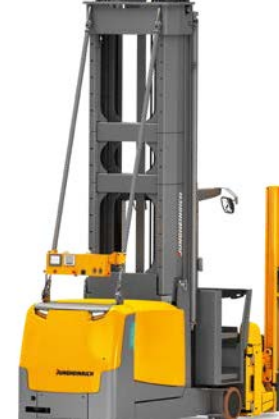
EKX 514a-516a Chariot automatisé (AGV) Hauteur de levée maxi : 13 000 mm Capacité de charge maxi : 1600 kg
