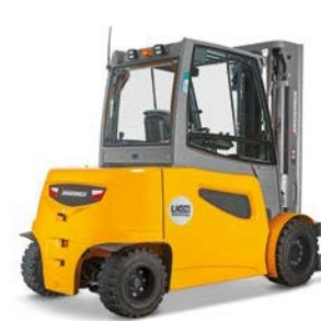
EFG 535k-S50 Chariot élévateur électrique quatre roues Hauteur de levée maxi : 7500 mm Capacité de charge maxi : 5000 kg
