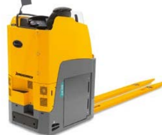
ESE 220-533 Transpalette électrique à conducteur assis Capacité de charge maxi : 3300 kg
