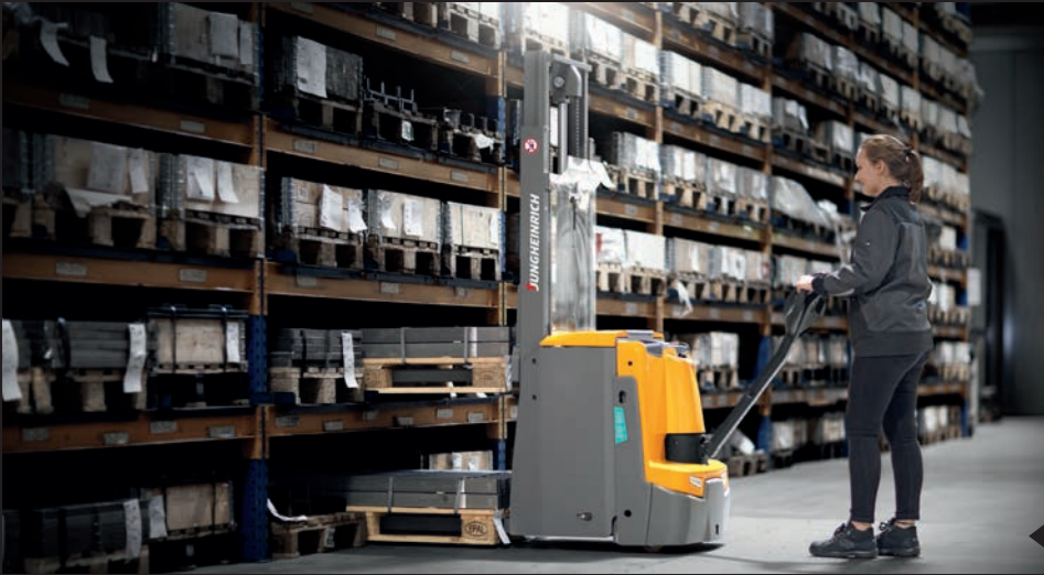
Doppelt so produktiv in derselben Zeit: Die Aufnahme von zwei Paletten im Doppelstock beim EJD 220 macht es möglich.
