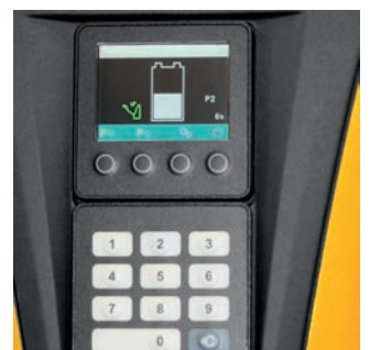
EMC 110: 2-Zoll-Fahrzeuginstrumente inklusive Entladeanzeige und Betriebsstundenzähler (optional).
