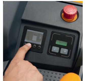
Alle wichtigen Parameter immer im Blick, z.B. Ladezustand oder geleistete Betriebsstunden.
