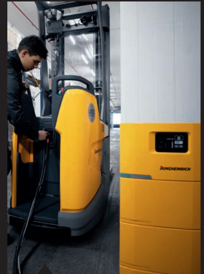
ERC 214zi/216zi mit Komfort-Ladekonzept. Die Ladeschnittstelle ist ergonomisch leicht erreichbar – für schnelles und häufiges Zwischenladen.
