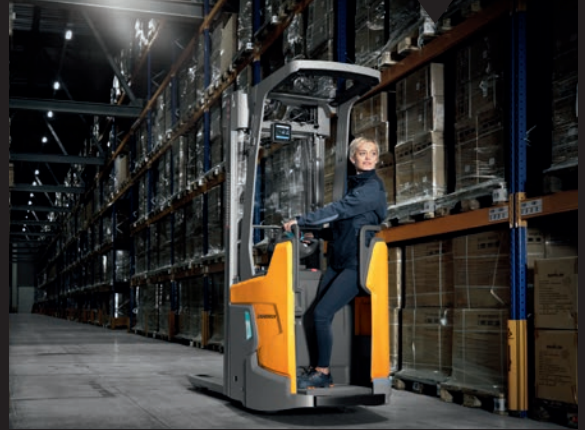
Sicherheit und Ergonomie für den Bediener bietet die feste Standplattform mit 3-Seiten-Schutz.
