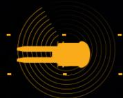
Posicionamiento preciso mediante navegación por láser o tecnología de guiado inductivo y transpondedores para carretillas de gran altura automáticas.
