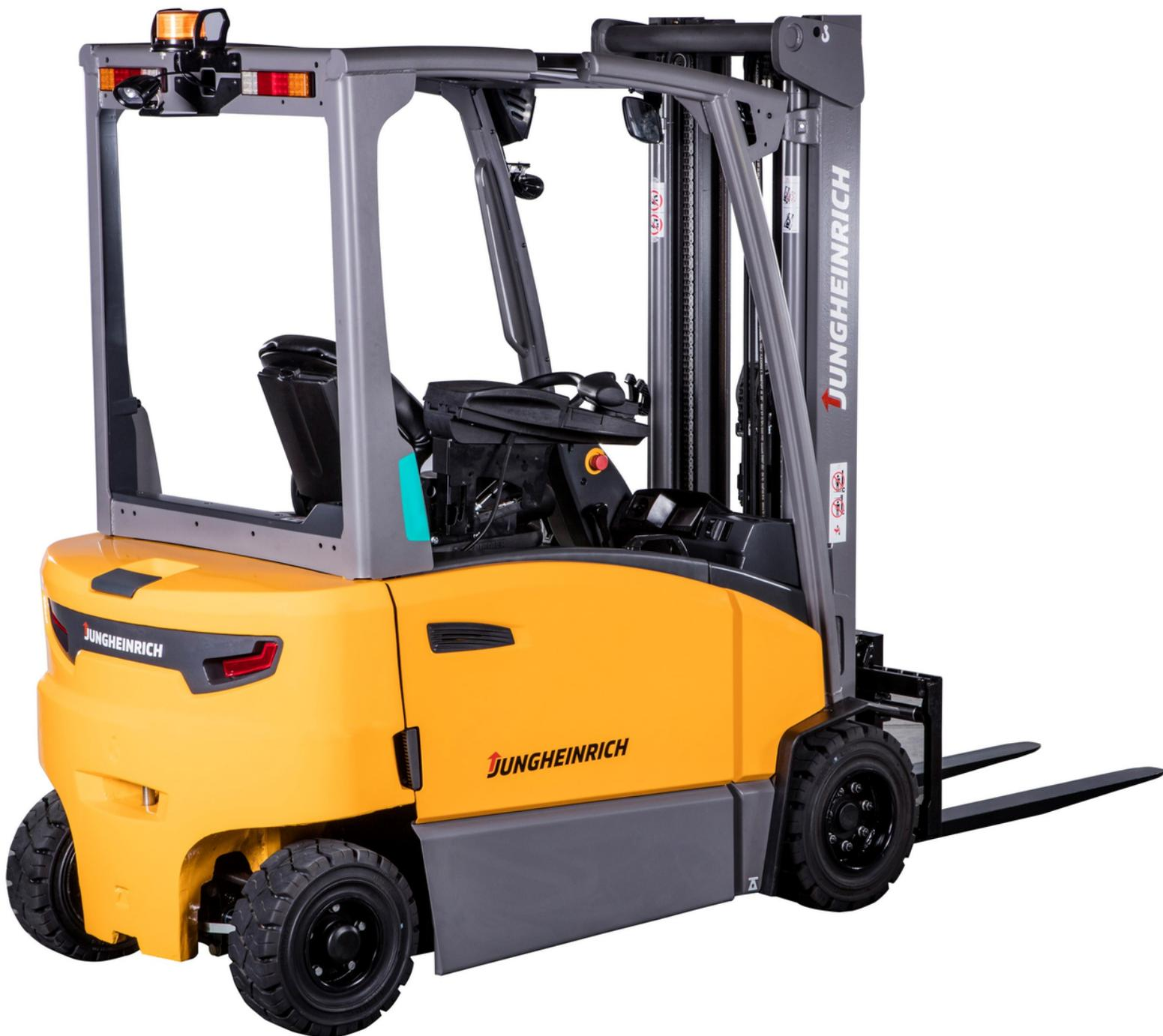
Электрический четырехколесный погрузчик
