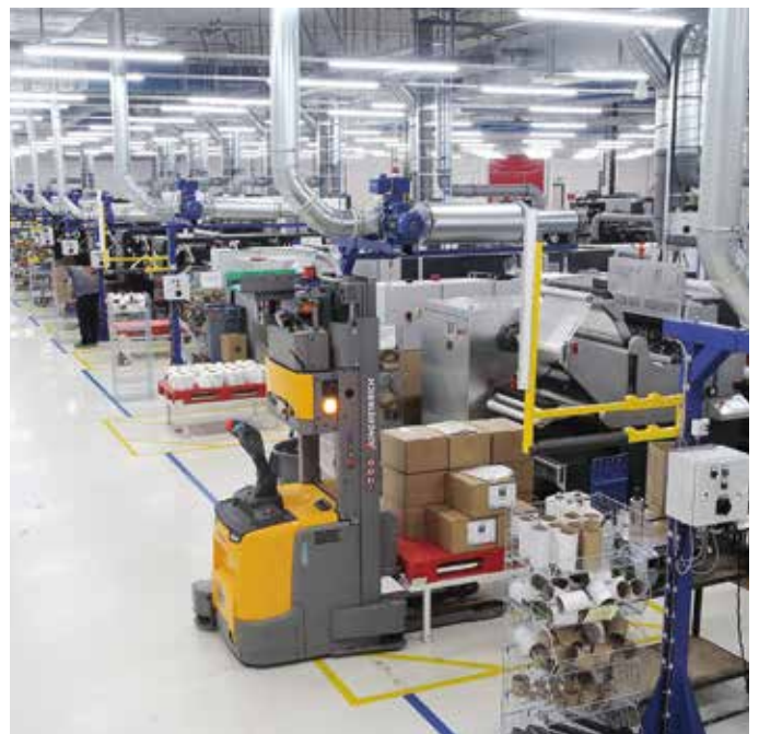
De AGV haalt na een druk op de knop de volle pallet op bij een werkstation.
