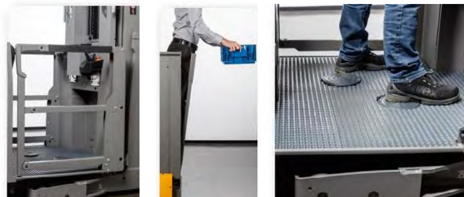
Ergonomická úroveň pedálu přítomnosti obsluhy s ergonomickou podlahovou rohoží ve vozíku EKS.
