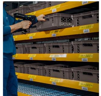
Durch das FIFO-Prinzip des Durchlaufregals lassen sich Chargen und Mindesthaltbarkeitsdaten gut überwachen.
