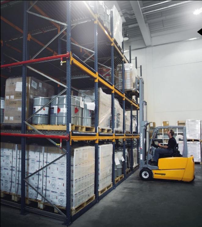
Das Einschubregal besitzt die höchste Lagerdichte bei geringstem Fahrweganteil. Die Be- und Entladung ist 30 bis 35 % schneller als beim Einfahrregal.
