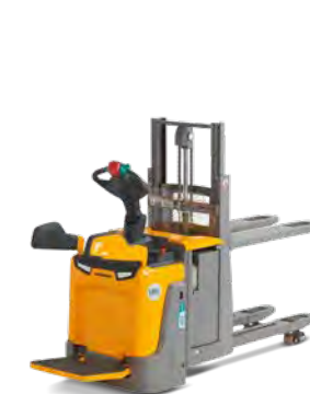
ERD 120/220 Podnośnikowy wózek widłowy podwójnego załadunku Maks. wys. podn.: 2 905 mm Maks. udźwig: 2 000 kg
