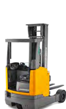
ETV C16/C20 Wózek widłowy wysokiego składowania Maks. wys. podn.: 7 400 mm Maks. udźwig: 2 000 kg
