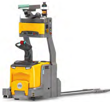
ERE 225a Robot mobilny Do transportu poziomego Maks. wys. podn.: 125 mm Maks. udźwig: 2 500 kg
