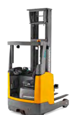
ETV 210-216/ETM 214/216 Wózek widłowy wysokiego składowania Maks. wys. podn.: 10 700 mm Maks. udźwig: 1 600 kg
