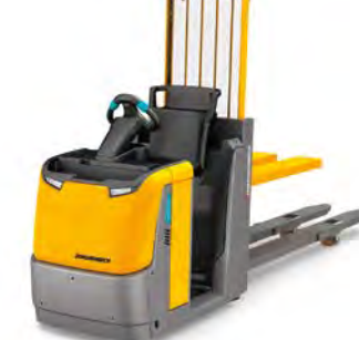
ECD 320 Wózek widłowy do kompletacji poziomej Maks. udźwig: 2 000 kg Opcja: easyPILOT
