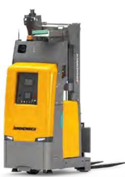
EKS 215a Robot mobilny Do transportu poziomego i pionowego Maks. wys. podn.: 6 000 mm Maks. udźwig: 1 500 kg
