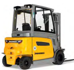
EFG 425–435 Czołowy czterokołowy wózek widłowy Maks. wys. podn.: 7 500 mm Maks. udźwig: 3 500 kg
