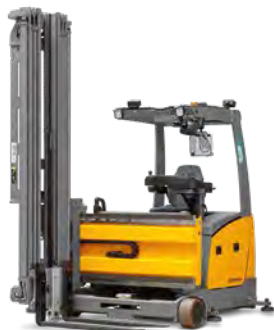
EFX 411/414*** Wózek widłowy trójkierunkowy Maks. wys. podn.: 9 000 mm Maks. udźwig: 1 360 kg
