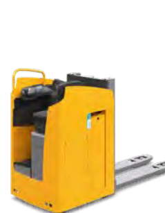
ESD 220 Podnośnikowy wózek widłowy podwójnego załadunku Maks. wys. podn.: 1 660 mm Maks. udźwig: 2 000 kg
