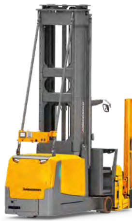
EKK 514a–516a Robot mobilny Do zautomatyzowanej pracy w wąskich korytarzach roboczych Maks. wys. podn.: 13 000 mm Maks. udźwig: 1 600 kg
