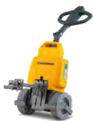
EZS 010 Ciągnik akumulatorowy z dyszlem Maks. uciąż: 1 000 kg
