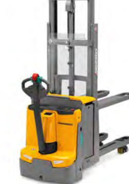
EJD 118i/120/222 Podnośnikowy wózek widłowy podwójnego załadunku Maks. wys. podn.: 2 905 mm Maks. udźwig: 2 200 kg
