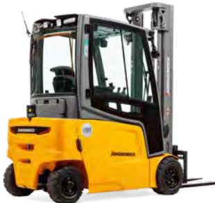
EFG 316–320 Czołowy trójkołowy wózek widłowy Maks. wys. podn.: 7 000 mm Maks. udźwig: 2 000 kg
