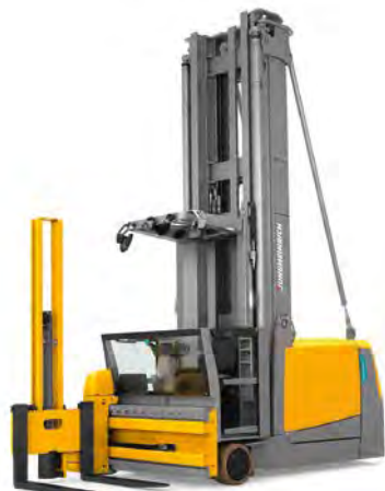
EKK 410–516k*** Wózek systemowy z podnoszoną kabiną i obrotową karetką widel Maks. wys. podn.: 18 000 mm Maks. udźwig: 1 600 kg
