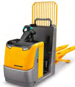
ECE 310/320 Wózek widłowy do kompletacji poziomej Maks. udźwig: 2 000 kg Opcja: easyPILOT
