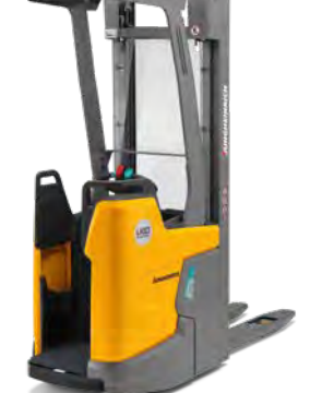
ERC 214i/216i** Podnośnikowy wózek widłowy z li-ion Maks. wys. podn.: 6 000 mm Maks. udźwig: 1 600 kg
