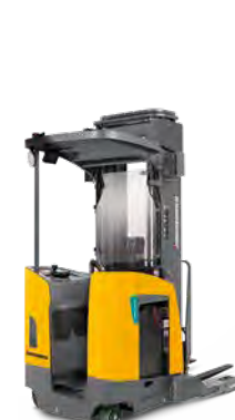
ETR 230-345/335d Pantograf Maks. wys. podn.: 11 354 mm Maks. udźwig: 2 000 kg
