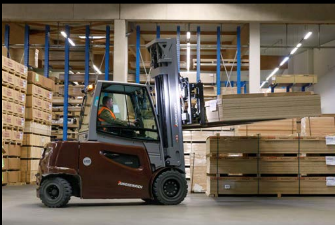
Verlängerte Gabeln nehmen die großen, schweren Holzlasten mühelos auf.
