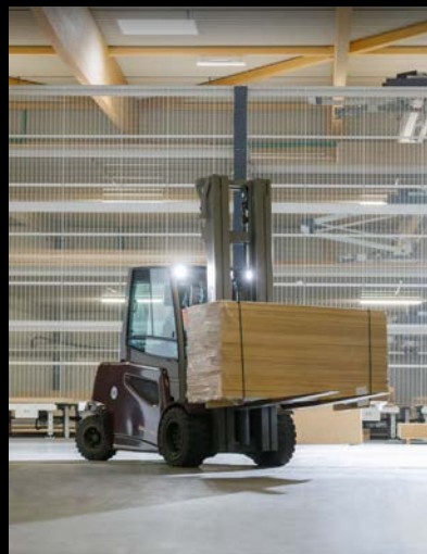
Verlängerte Gabeln nehmen die großen, schweren Holzlasten mühelos auf.
